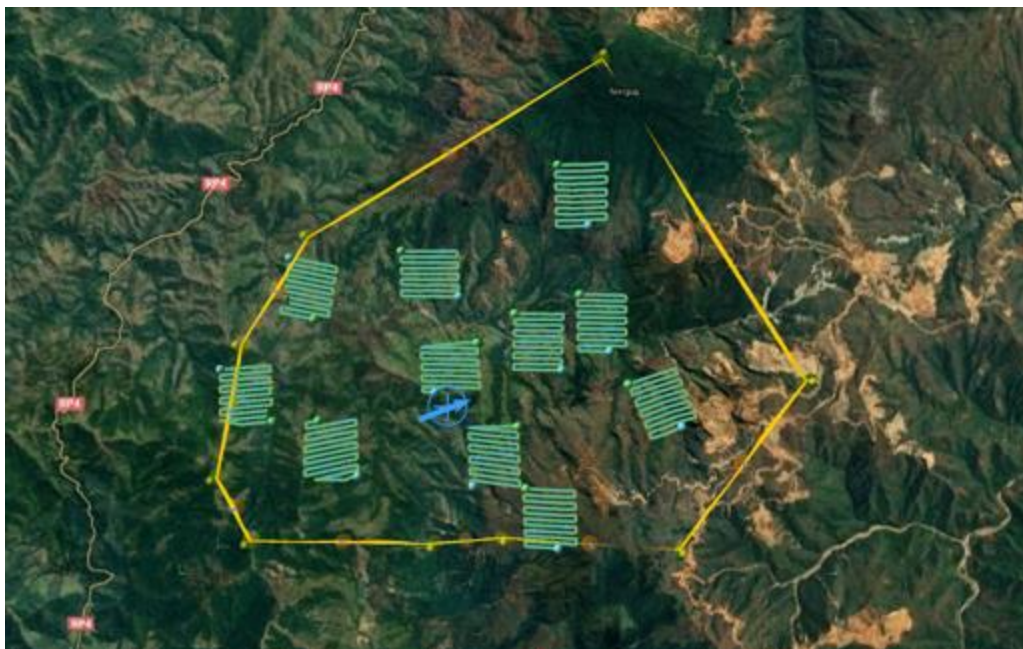
Figure 52 : Représentation des différents plans de vol de la partie A de la zone prioritaire de Thio. Missions éditées à l'aide de l'application de programmation de plan de vol automatisé et basées sur l'emplacement théorique de sélection aléatoire.
