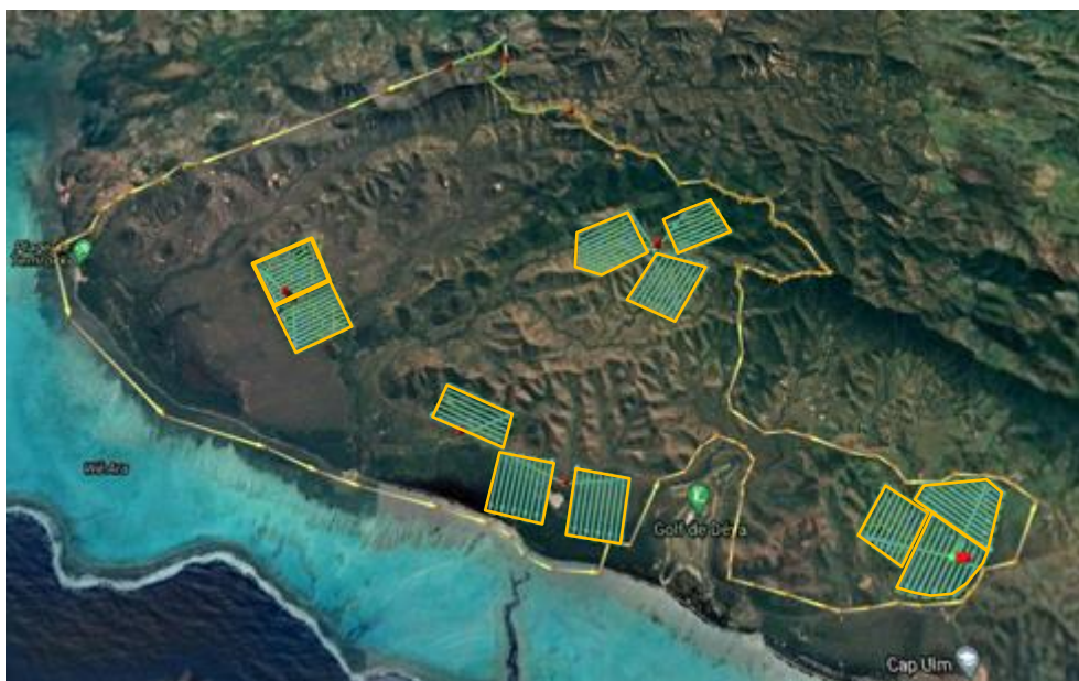
Figure 26 : Ensemble des missions drones avec capteur thermique réalisées au cours de l'étude en mode balayage de zone et suivi de terrain sur le Domaine de Déva (Bourail).
