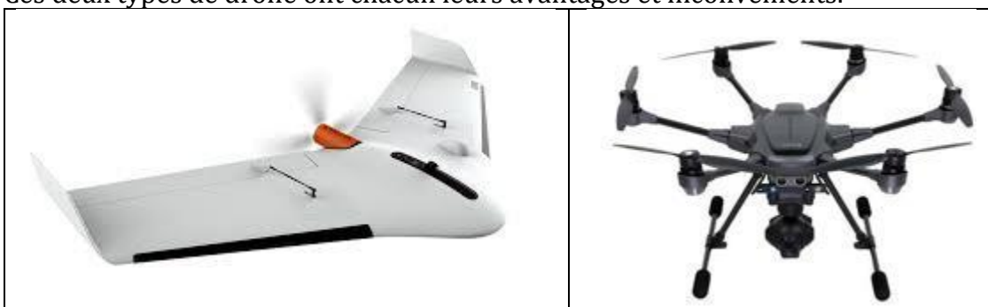
Figure 9 : Aile volante (à gauche) et hexacopter (à droite)
