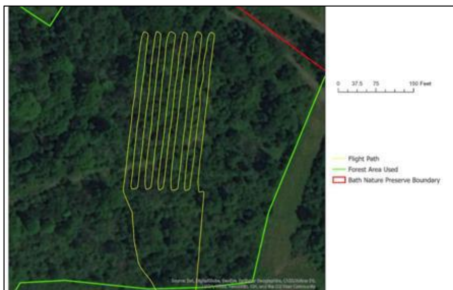
Figure 4 : Exemple de trajectoire de vol en balayage de zone tiré de l'étude de Maxwell C.Ott, 2020, sur l'utilisation des drones avec un capteur thermique pour cartographier et compter des populations de cerf.
